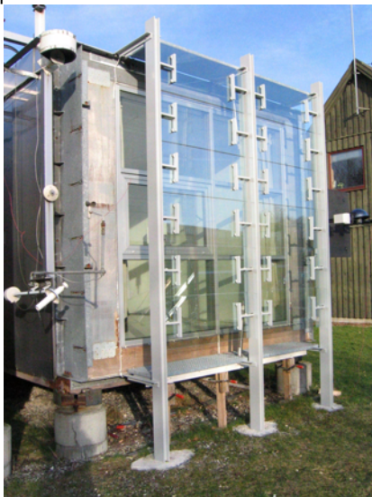
Solafskærmningssystemet med lamellerne i afskærmende position (Foto Jacob B. Laustsen, DTU Byg)
